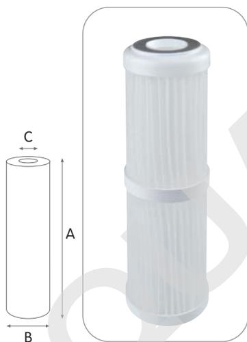
Le cartucce in rete lavabile di polipropilene con filtrazione nominale 50 micron sono progettate per fornire un'elevata portata con basse perdite di carico. Le cartucce RS offrono un'ampia superficie filtrante. Altezza da 4" a 20".
