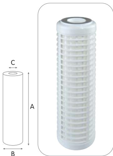
Le cartucce in rete lavabile con filtrazione nominale 50 micron consentono un flusso uniforme d'acqua e perdite di carico molto basse. Le cartucce vengono prodotte senza colla e sigillanti, e le reti vengono stampate sul supporto rigido strutturale (armatura). Cartucce con supporto rigido progettate per elevata resistenza e durata, con altezza da 4" a 20".
