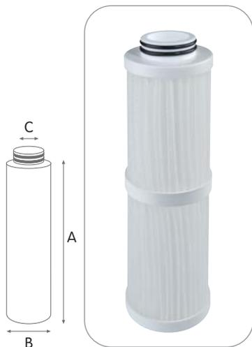
Le cartucce in rete lavabile di polipropilene con filtrazione nominale 50 micron sono progettate per fornire un'elevata portata con basse perdite di carico. Le cartucce RS offrono un'ampia superficie filtrante. Altezza da 5" a 20".
