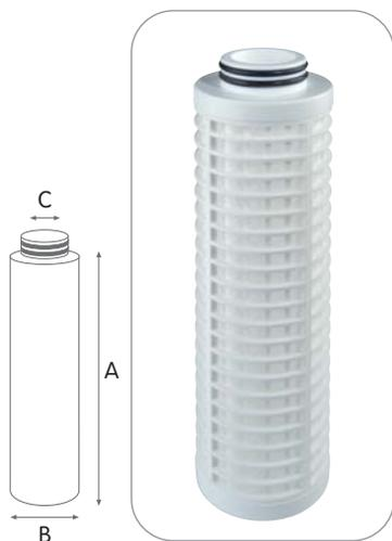
Le cartucce in rete lavabile con filtrazione nominale 50 micron consentono un flusso uniforme d'acqua e perdite di carico molto basse. Le cartucce vengono prodotte senza colla e sigillanti, e le reti vengono stampate sul supporto rigido strutturale (armatura). Cartucce con supporto rigido progettate per elevata resistenza e durata, con altezza da 5" a 20".
